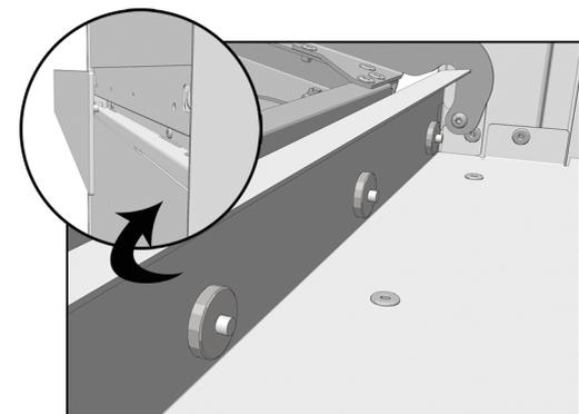
Auf der Innenseite des jeweiligen Fachs, befinden sich 4 Kunststoffschrauben, welche mit der Hand gelöst werden können. Dadurch löst sich die kleine darunter liegende Blende. Bitte beim Lösen, festhalten!
