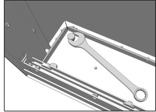
Die Box passend auf die bereits platzierten Bohrlöcher mit Dübel stellen und die Schrauben mit Unterlegscheibe und mit Hilfe eines 13er Maulschlüssels anziehen.
