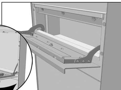
Bei Standbriefkästen mit Zeitungsfach: nun das Zeitungsfach öffnen.
