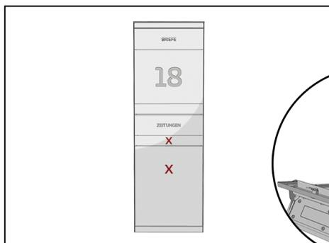
Standbriefkasten vorbereiten. Die Verschraubungen sind im Fuß des Kastens versteckt. Zur Befestigung, muss die untere große Blende und die kleine darüberliegende Blende einmalig entfernt werden. Bitte nächste Schritte befolgen.
