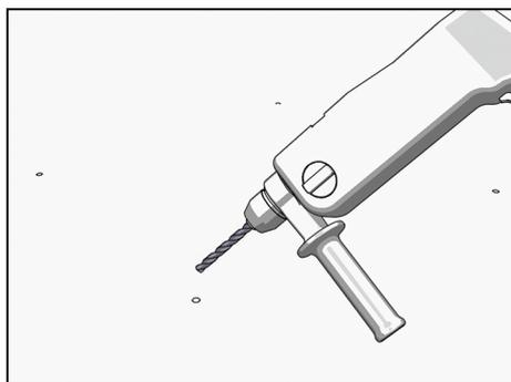
Bohrlöcher mit einem 12er Bohrer an gekennzeichneten Stellen bohren.
