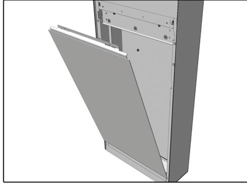
Große Blende vorsichtig entfernen. Nun sind die Bohrlöcher im Fuß der Box zugänglich für die Verschraubungen.
