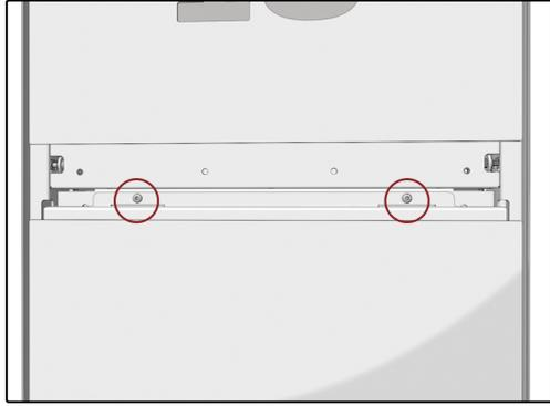
Nach Entfernung der kleinen Blende, können die 2 Verschraubungen der großen Blende gelöst werden.
