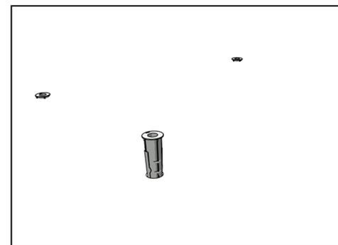
Mitgelieferte Dübel in die Bohrlöcher setzen.
